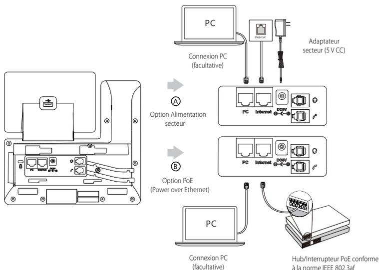
Remarque : Le téléphone IP doit seulement être utilisé avec l'alimentation Yealink (5V/2A) d'origine. L'utilisation d'un adaptateur secteur tiers peut endommager le téléphone. Si vous connectez un ordinateur à votre téléphone, nous vous recommandons d'utiliser le câble Ethernet fourni par Yealink.
