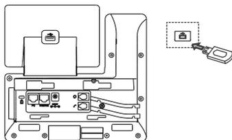
Remarque : Le port USB (derrière le téléphone) peut également être utilisé pour connecter le module d'extension à écran couleur EXP50 ou le casque USB. Pour plus d'information sur comment utiliser le EXP50, se référer au guide utilisateur des Yealink EXP50. Pour plus d'information sur comment utiliser le casque USB, se référer à la documentation du constructeur.
